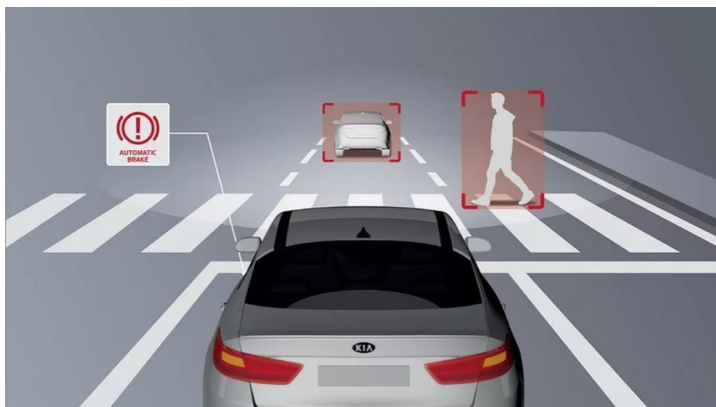
Рисунок 2.8 - Автоматическое торможение и предупреждающий сигнал на панели
