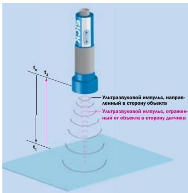
Рисунок 1.6 – Принцип работы ультразвукового датчика
